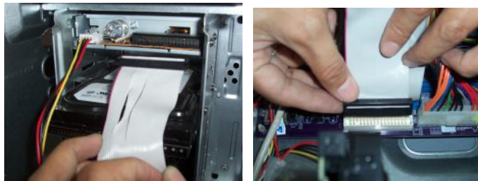
Gambar 3. 12. Pemasangan kabel data di floppy disk drive dan di mainboard
